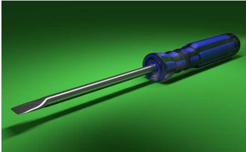
شكل رقم ٩: المفك العادية (المببط) Slotted Screwdriver
