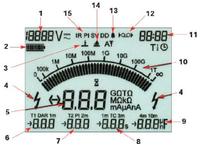
شكل رقم ٣٢: صورة توضح احد اشكال شاشات الميجر
