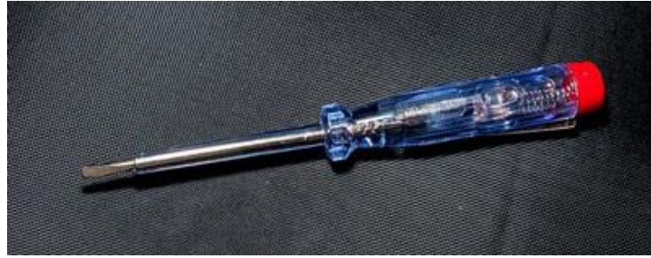
شكل رقم ٢٨: صورة لمفك اختبار
