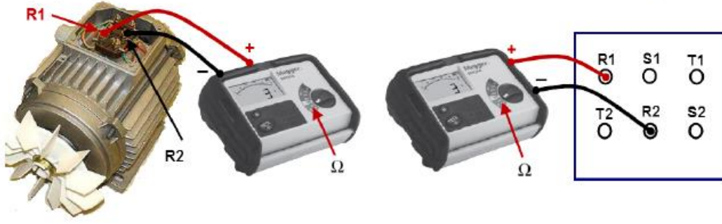
شكل رقم ١٠٥: قياس استمرارية التوصيل في محرك كهربائي باستخدام جهاز الميجر
