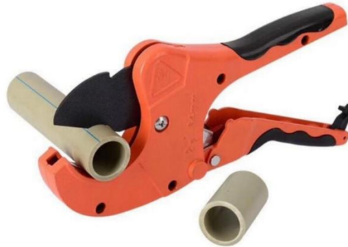
شكل رقم ١١٥: سكين قطع المواسير البلاستيك PVC
