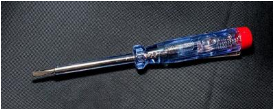
شكل رقم ١٠٣: صورة لمفك اختبار
