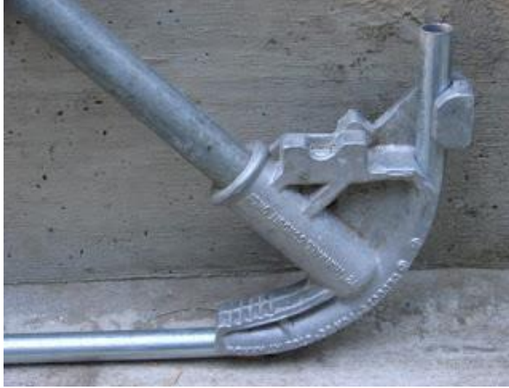
شكل رقم ٨٢: جهاز الثني المستخدم لثني المواسير
