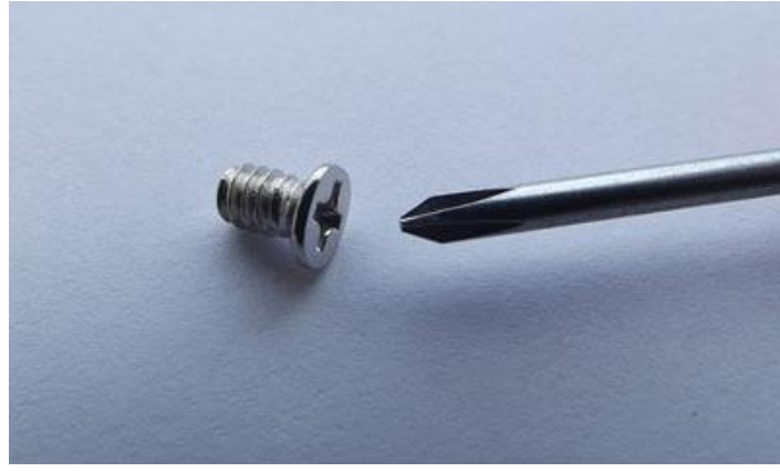
شكل رقم ١٠: مفك براغي فيليبس مع مسمار برأس صليبي
