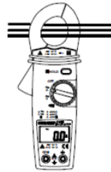
طريقة خاطئة لقياس التيار
