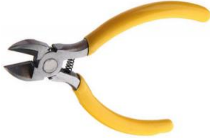
شكل رقم ٢٢: زردية القطع - القصافة (Cutter Plier)
